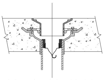
☐ PART NO. TG34IP 3" INSERT FITS INSIDE 4" CAST IRON OR PLASTIC PIPE
