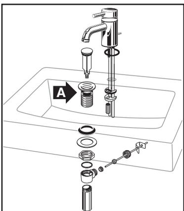
Instale el conjunto de grifo y drenaje (no incluido) en el lavabo de acuerdo con las instrucciones del fabricante. Asegúrese de aplicar una base de masilla para sellar en la parte inferior del drenaje (Pieza "A"), a fin de garantizar un sellado hermético entre el lavabo y el drenaje. Retire el exceso de masilla después de ajustar el drenaje en el lavabo.
