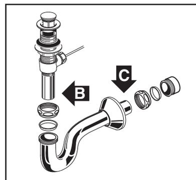
Conecte la trampa al conjunto del drenaje y ajuste con la mano para verificar la alineación. Puede que deba cortar parte de la cola (área "B") o parte de la pata horizontal de la trampa (área "C"). Ajuste las uniones para tener un ensamble hermético.
