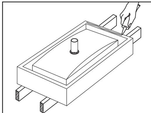
Después de verificar el ajuste y la alineación, coloque el lavabo al revés y aplique una generosa cantidad de adhesivo de silicona alrededor del lado inferior del borde. Vuelva a colocar el lavabo en su posición. Quite el exceso de adhesivo.
