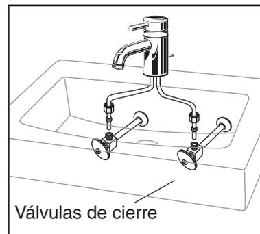
Conecte la línea de suministro al grifo (apriete firme con los dedos) y doble cuidadosamente los tubos para conectarlos con las válvulas de corte del suministro. Apriete las conexiones del grifo y las válvulas de corte para asegurar el sellado.
